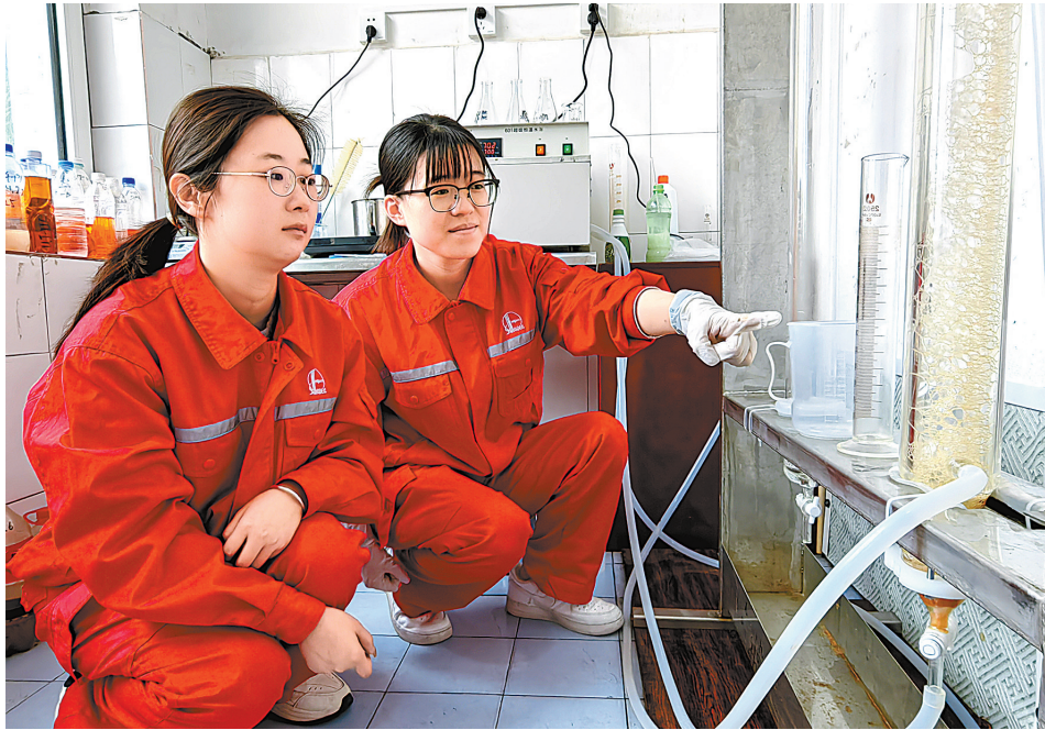
东胜气田员工在查看泡排剂的发泡效果和携液率。
