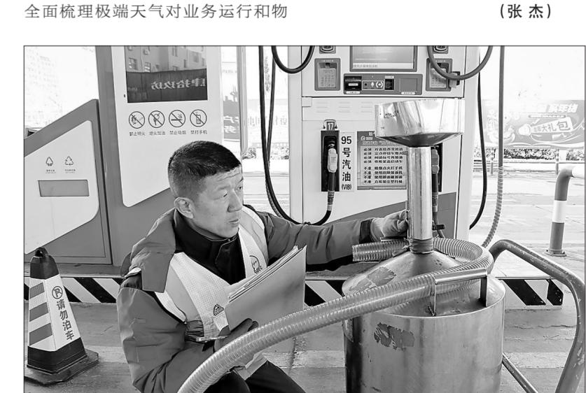
“3·15国际消费者权益日”即将来临,山东滨州石油进一步强化加能站油品质量管理,用50升标准计量器对加油机加油枪逐个进行精度检测,细致检查加油机铅封,每日对所有加油枪进行“提枪走字”检查,确保让客户加到质优量足的油品。图为2月27日山东滨州石油员工读取计量器数据。
