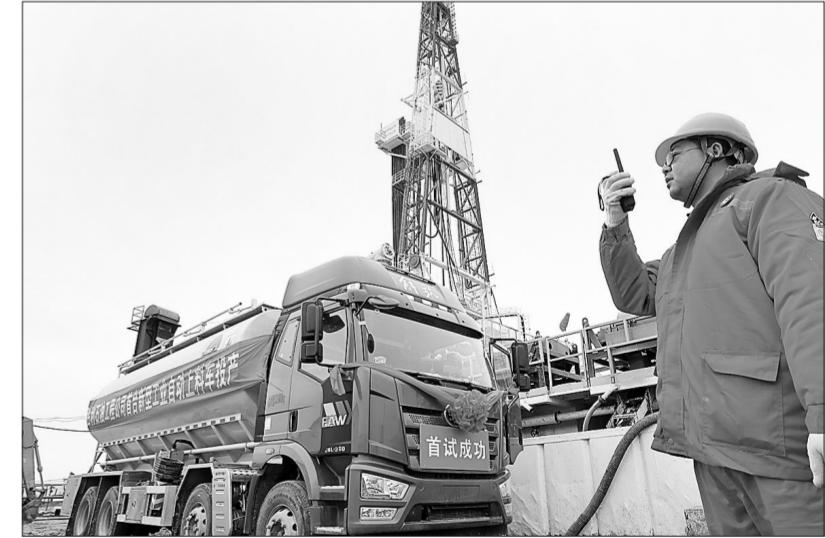
近日,胜利石油工程公司首台工业盐自动上料车在50427钻井队现场正式投产,实现了去包装、减人工、自动化的工业盐绿色供应。图为工业盐自动上料车正在对井场循环罐加注工业盐。
