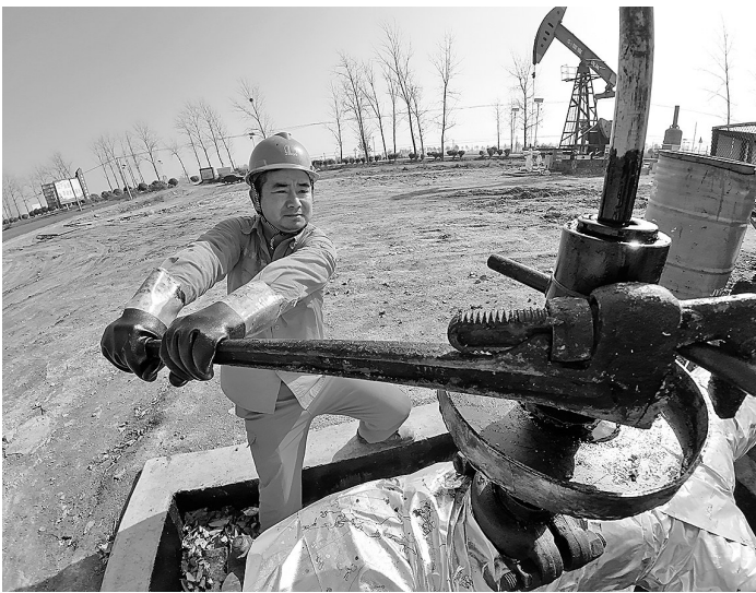
河南油田加快勘探开发一体化研究,紧盯注汽焖井、放喷排液、下泵投产等关键节点,全力保障复产并快速上产。今年8月中旬开始复产的付湾油田日产原油17.6吨,产量稳中有升。图为12月9日,古城采油管理站员工黄涛在付湾2井紧固盘根。戚剑峰 摄 肖超 文
