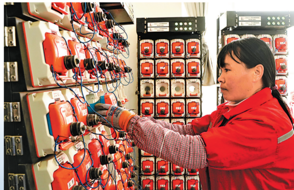
节点管理人员每天要对3600个节点仪进行数据下载、充电,确保第二天设备“能量满满”。
