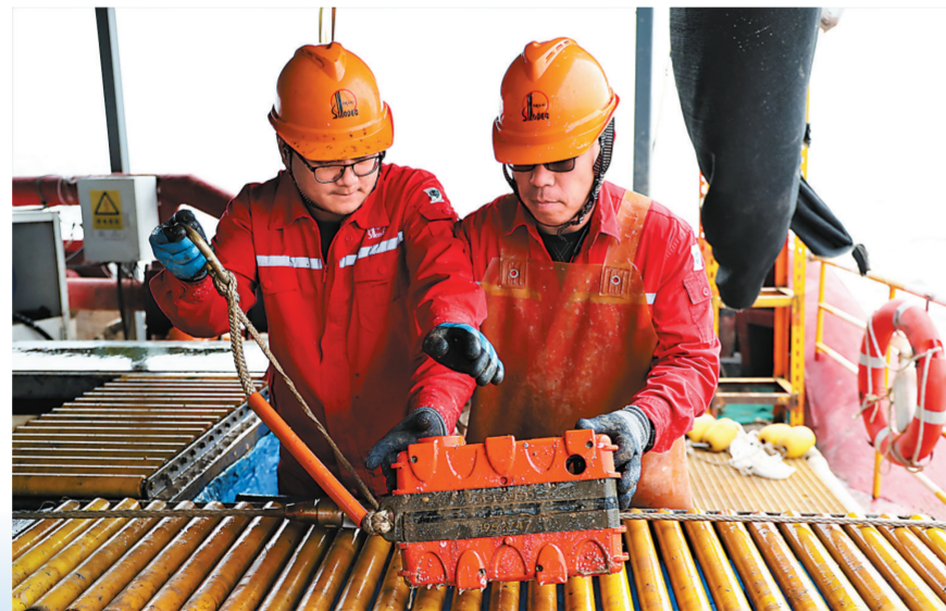
两名施工人员正在清理OBN(海底节点仪)。OBN可24小时在海底独立采集、记录地震信号。
