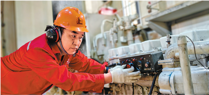
轮机长正在检查气枪空压机运行状况,确保设备高效运转。
