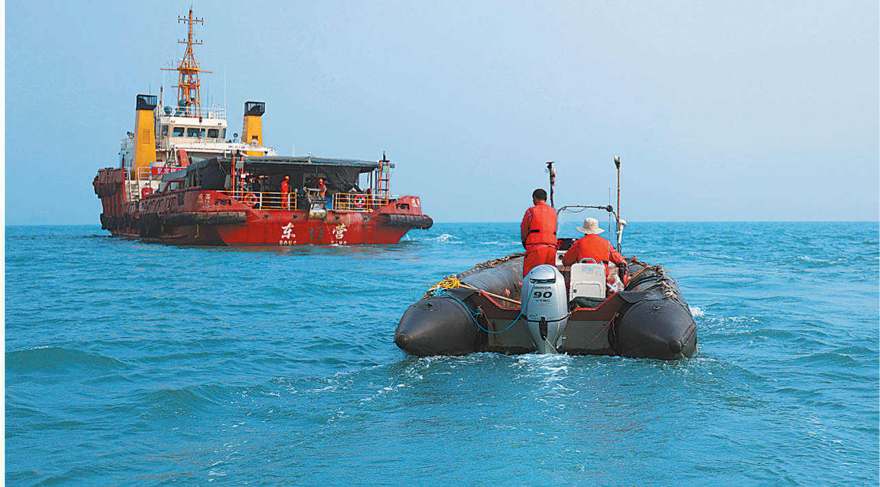
机动橡皮艇配合节点收放缆船进行收放缆作业。
