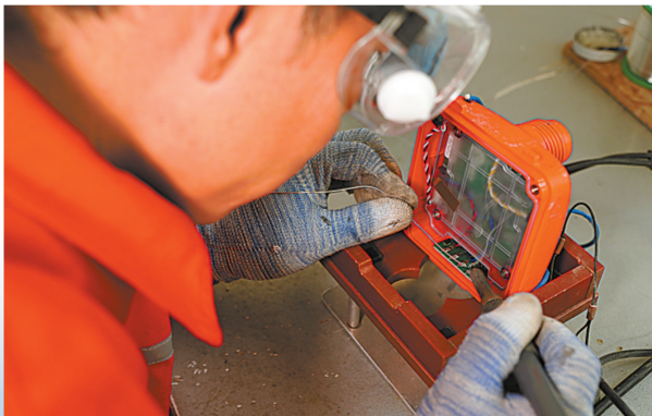
检修房内,维修人员在维护节点仪器,确保节点仪接收信号良好。
