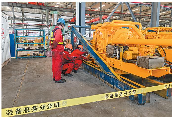
江汉石油工程顶驱工程师正在对顶驱进行精心维修。 陈琳 胡娟 摄影报道
