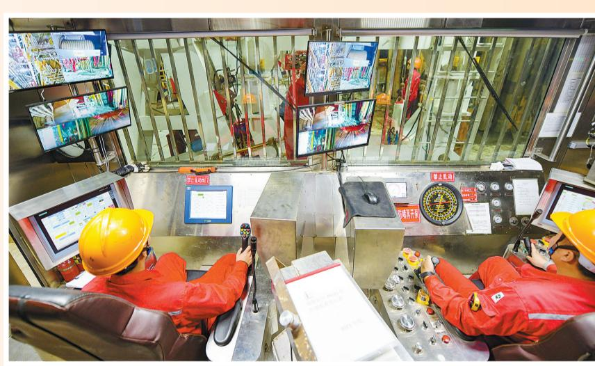
胜利石油工程公司钻井平台司钻与副司钻在司钻房内进行起下钻施工。 王福 摄
