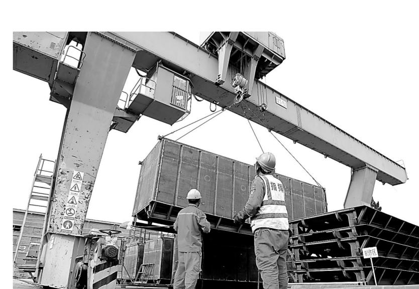
连日来,中原石油工程公司工程服务中心克服连续高温天气带来的困难,加快泥浆罐、双层油罐、爬犁、工房等设备加工制造进度,为钻井生产提供有力装备保障。图为该中心钻采设备厂员工吊装泥浆罐体。
