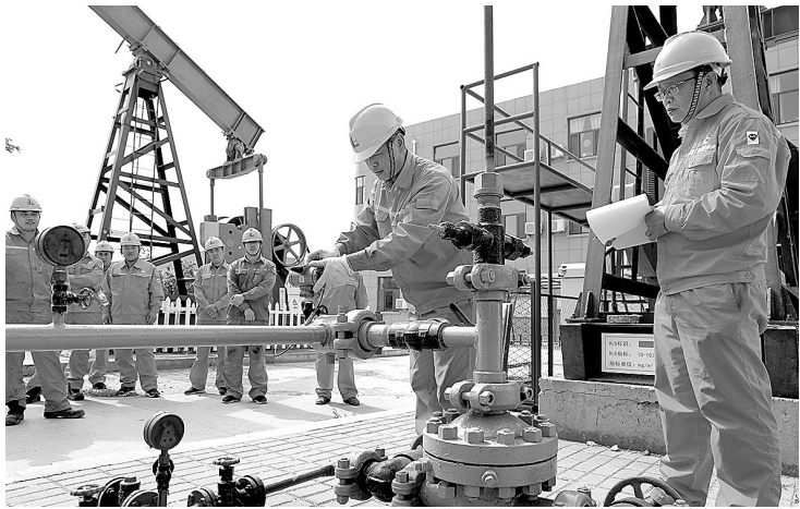
孤岛采油厂更换无线温压一体变送器模拟技能鉴定现场。李超君 摄
