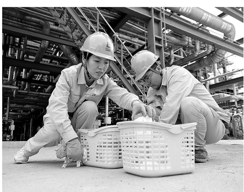
近日,齐鲁石化博士后工作站开展“原油脱酸与装置运行”专项研究,科学分析高酸原油对装置运行的影响,为公司技术升级改造项目提供技术支持。图为博士后工作站研究人员在现场分类试验样品。
