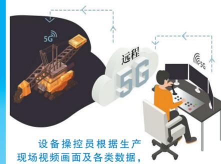
设备操控员根据生产现场视频画面及各类数据,远程实时对现场工业设备进行精准操控。
