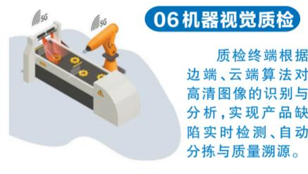
质检终端根据边端、云端算法对高清图像的识别与分析,实现产品缺陷实时检测、自动分拣与质量溯源。
