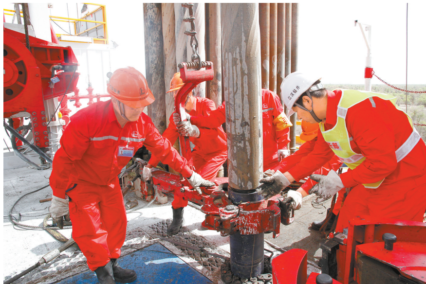
钻井人员正在接钻具,为跃进3-3井开钻施工做好准备。
