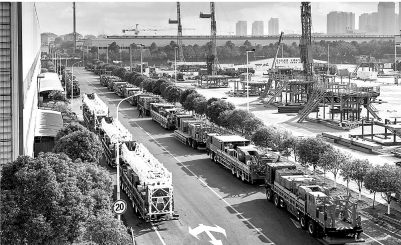
石化机械四机公司超大功率SCF连续满载全电动压裂机组。孙海涛 摄
