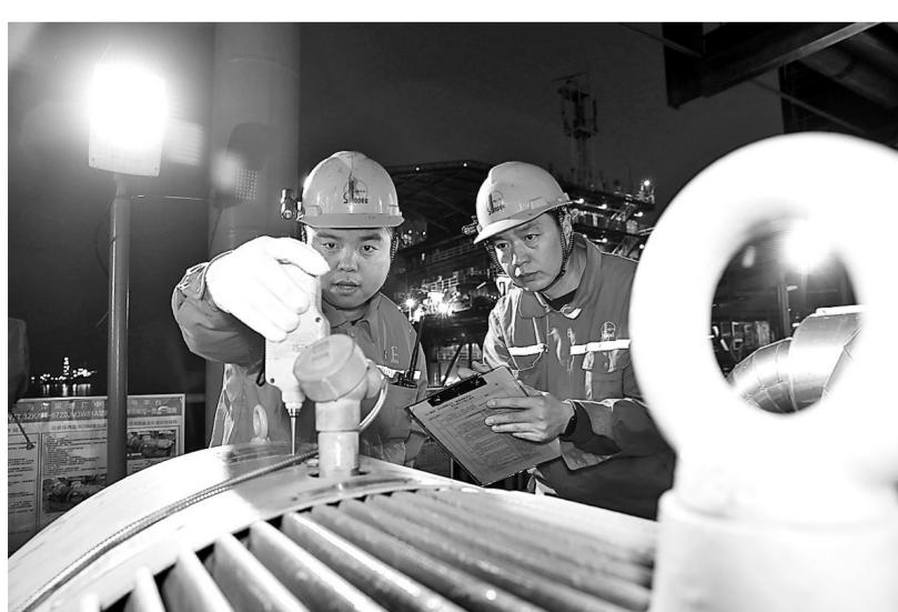
胜利油田海洋采油厂中心三号平台实施员工巡检“表单化”管理,分类梳理出变配电、油、气、水处理等600多项日常巡检要点,借助便携式气体检测仪、测振仪、热成像仪等专业设备进行检测。图为4月4日员工对照表单逐项检查外输泵、注水泵运行状态。 张灿 摄
