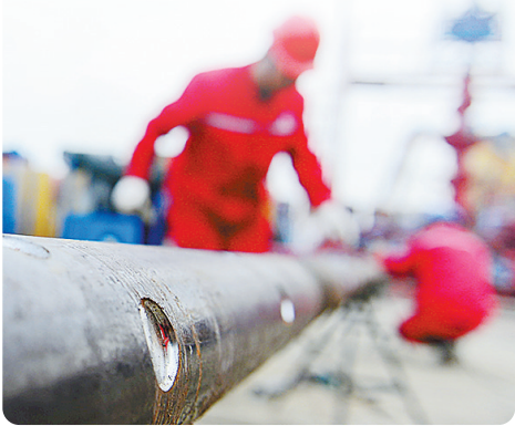
华东油气员工在组装页岩油井射孔枪。 沈志军 摄
