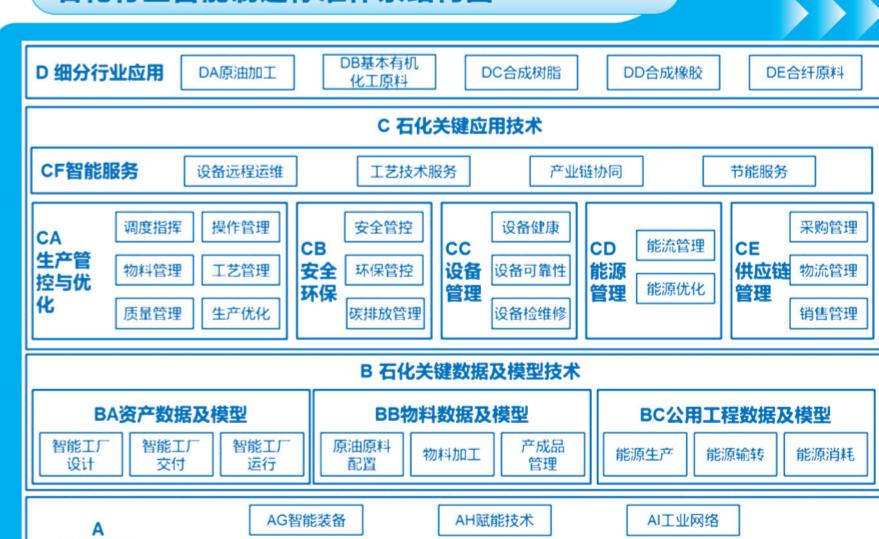
石化行业智能制造标准体系结构包括“**A基础共性**”“**B石化关键数据及模型技术**”“**C石化关键应用技术**”“**D细分行业应用**”4个部分。
