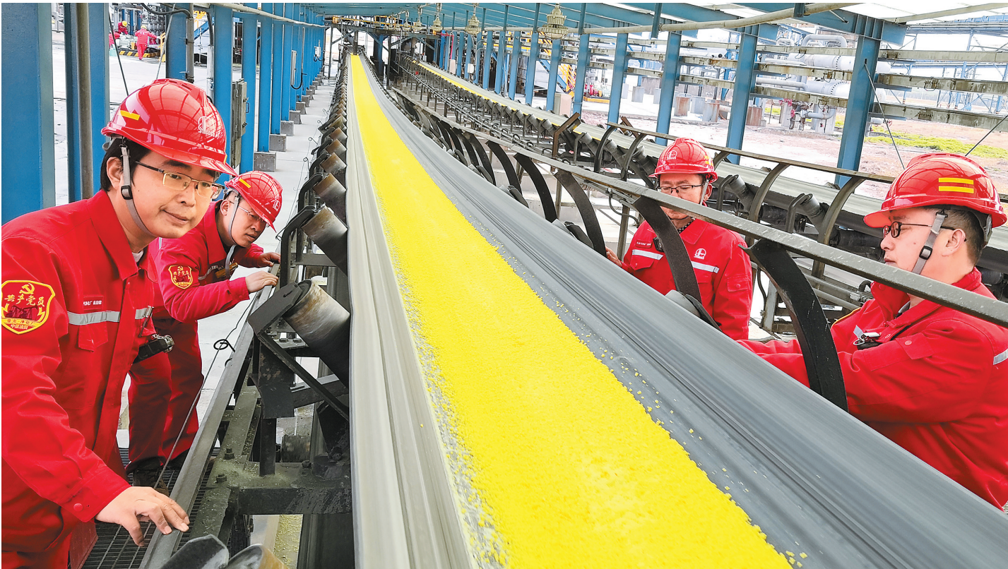
▲中原油田普光气田是目前国内最大的硫黄生产基地。进入春耕备耕期后,普光气田加大硫黄增产增供力度,全力保障化肥原料供应。图为天然气净化厂储运车间党员突击队查看硫黄传送带运行情况。 汪作庆 摄 白国强 文
