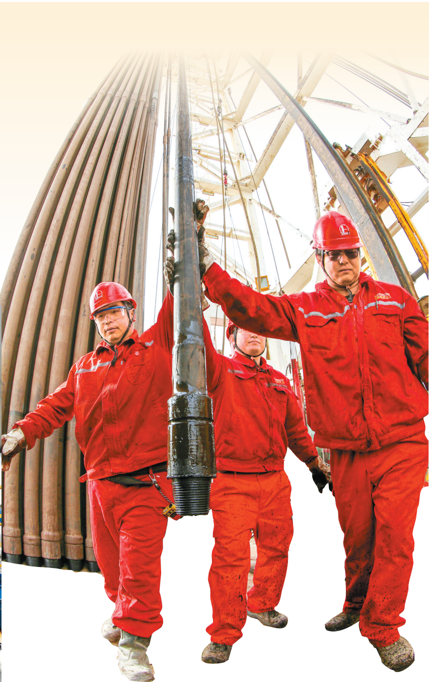
▲顺北5号条带是西北油田顺北油气田开发较早的区块。顺北油气田不断完善该区块的注采井网,为后期寻求新的上产潜力打牢基础。图为施工人员进行提管作业。 李学仁 摄
