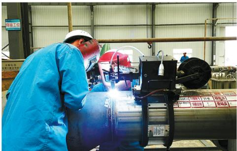
十建公司采用全位置固定自动焊接技术进行工艺管道安装焊接,比传统手工焊接技术提高工效近4倍,为高质量推进重点项目建设提供技术保障。图为2月14日,该公司员工在管道数字化车间进行管道焊接。 刘建国 摄 田元武 文
