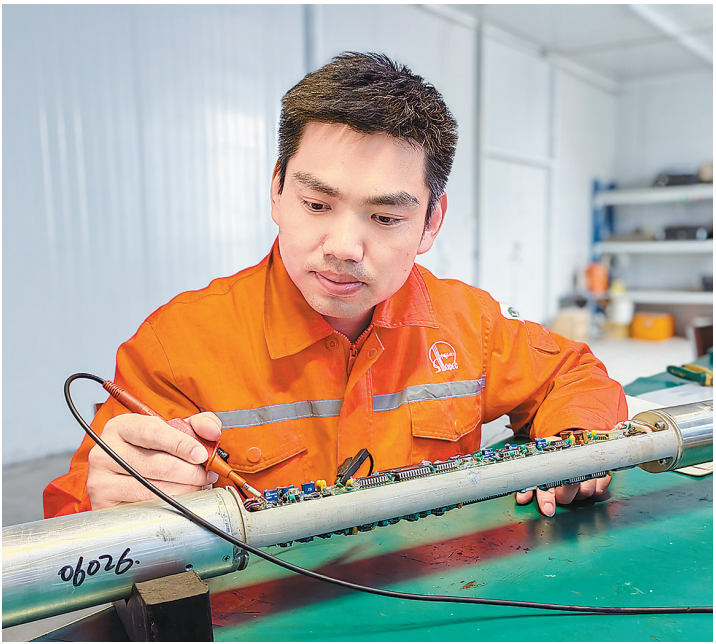
宋江波聚精会神维修射孔定位仪器。 丁静摄
