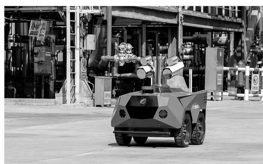
本报讯 11月10日,防爆式轮式巡检机器人在中科炼化420万吨/年催化裂化装置正式“上岗”。该巡检机器人体搭载导航设备和感知设备,可全自动或半自主替代或辅助人工巡检,开展一些烦琐重复、危险环境及人力无法完成的工作。这是中科炼化建设智能化、信息化工厂和设备智能化建设的重要一
