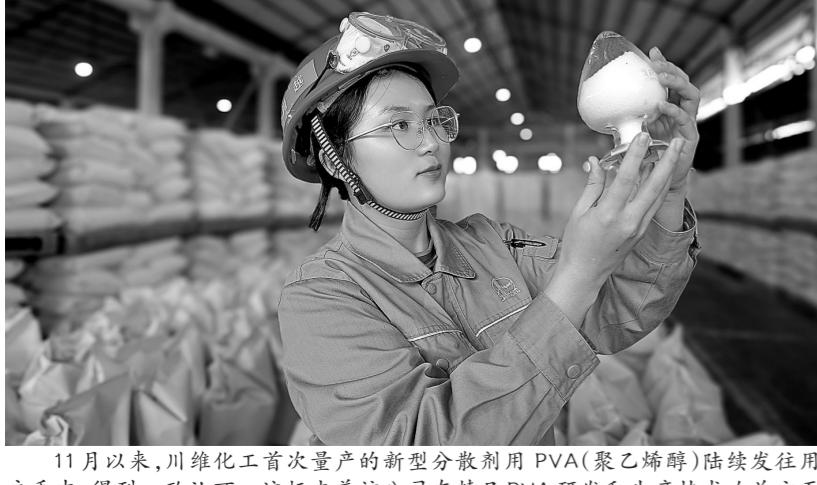
11月以来,川维化工首次量产的新型分散剂用PVA(聚乙烯醇)陆续发往用户手中,得到一致认可。这标志着该公司在精品PVA研发和生产技术攻关方面取得成功。新产品进一步满足了特种纸等高端领域的市场需求,拓展了增效空间。图为技术员检查新产品质量。胡德俊 摄
