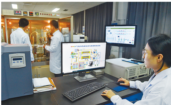
胜利油田勘探开发研究院技术人员在CCUS实验室内利用气驱非均质模拟系统进行实验。朱克民摄
