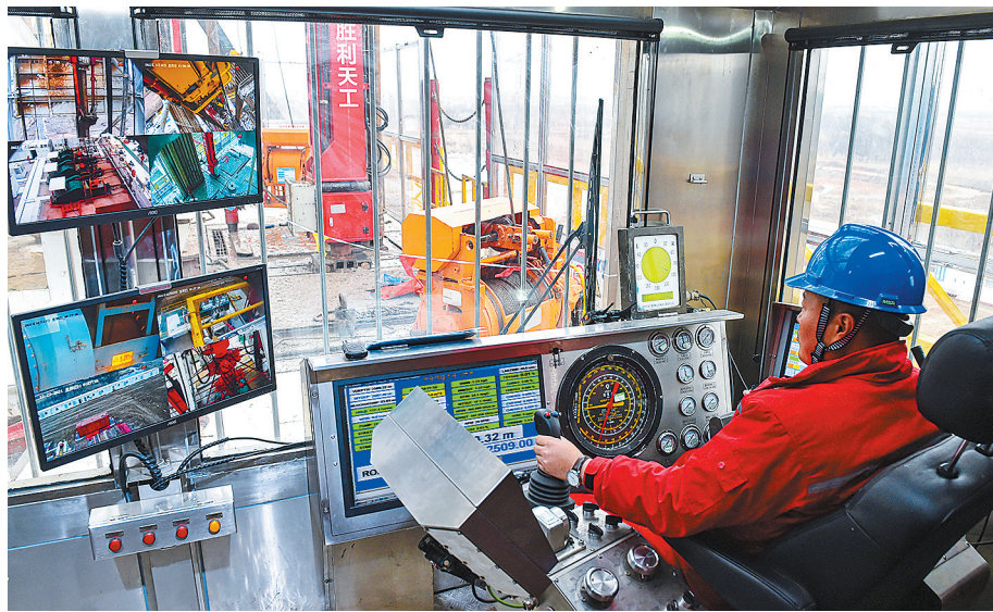
黄河钻井70183队司钻通过触摸屏和手柄,实现钻机自动化集成控制。
