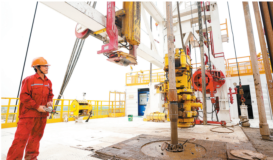
作业人员手持遥控器操作钻台机械手,完成立柱排放。
