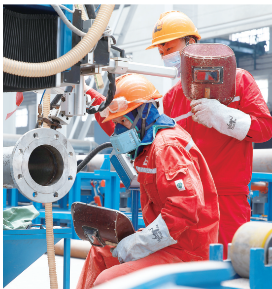
在胜利油建工程有限公司金属结构厂,焊工用全自动焊接作业线焊接撬块接管。
