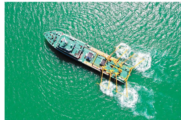
胜利707气枪震源船实施激发作业。该项目采用双气枪震源高效采集模式施工,成功应用自主研发导航软件,施工效率大幅提高。
