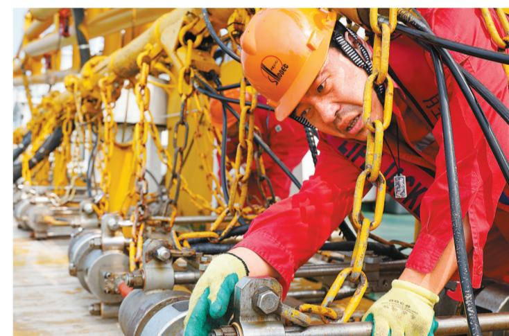
气枪震源船船员利用转测线间隙,提起气枪准备养护维修。
