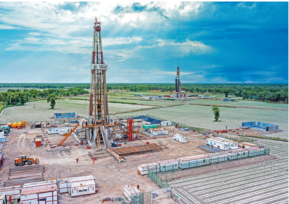
西北油田通过规模应用短半径侧钻技术,推动塔河老区油气开发降本提效。与传统侧钻技术相比,短半径侧钻技术钻井周期缩短80%,钻井费用降低60%。图为该油田TP278CH2井近日进行短半径侧钻施工。
