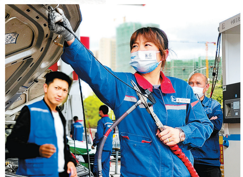
贵州黔南石油都匀西环加油站严格执行压缩天然气加气作业操作规程，图为6月15日，加油站员工执行充装前安全检查步骤，为车辆加挂防脱钩。陈董花摄
