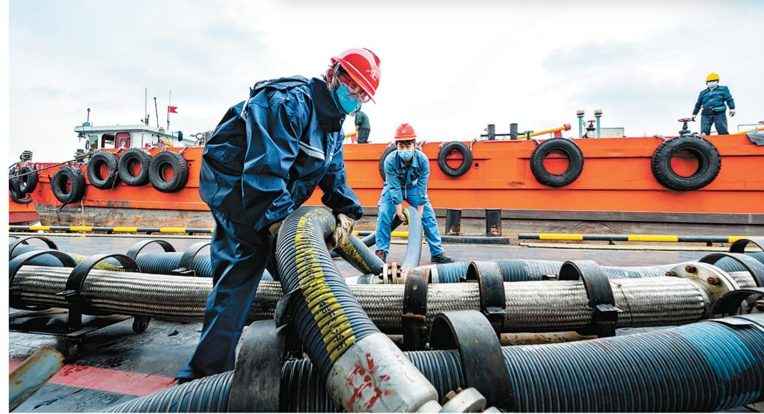
油轮停靠在高桥石化黄浦江码头,操作人员布置输油管准备装运高品质润滑油。
