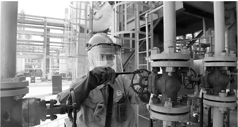
镇海炼化烷基化装置是生产高标号汽油的关键装置,他们抓好疫情防控和精细操作,保证了前4个月高标号汽油足量稳定供应。图为外操人员调整碱液流量,保装置平稳生产。郭海艳 摄
