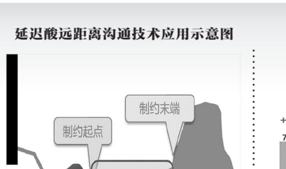
常规酸缓释性能差,有效反应时间短,无法完全疏通酸化目标段,导致“储集体2”无法动用。延迟酸技术将缓释时间由30分钟延长至180分钟,可有效动用远距离储集体目标。多项指标对比表明,延迟酸较常规酸现场应用效果更好。
