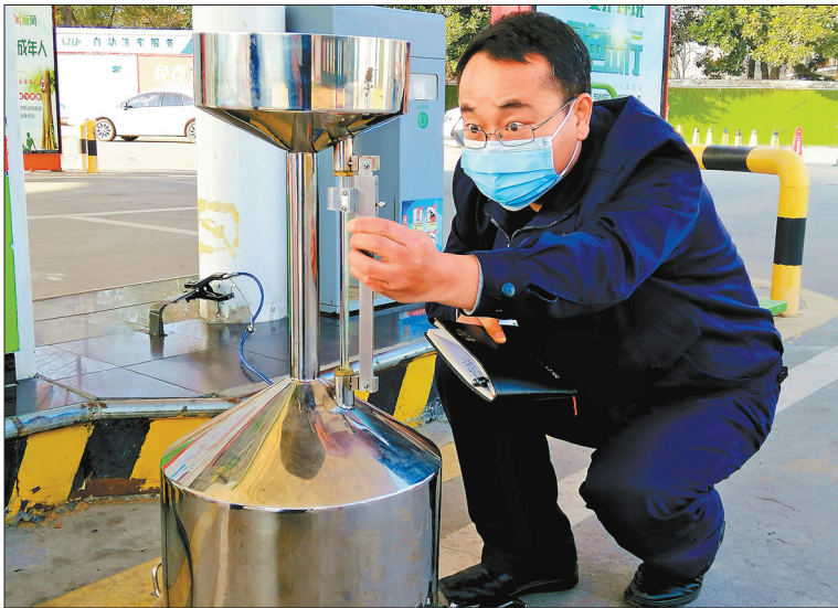
沈猛校验加油机发油准确度。
