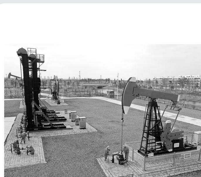
图为胜利油田综合提升示范基地辛37-7站,通过对工艺技术、电力技术等进行改造升级,抽油机轴承免维护周期从半年延长至8年。
