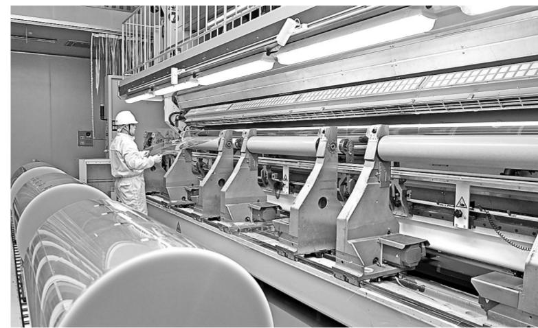
图为仪化东丽公司制膜三车间操作工进行分切贴膜上卷作业。刘玉福 摄
