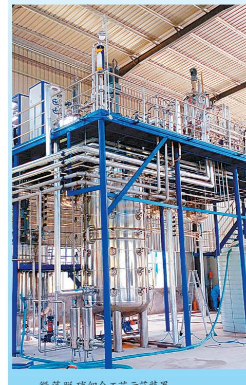
微藻脱硝组合工艺示范装置。
