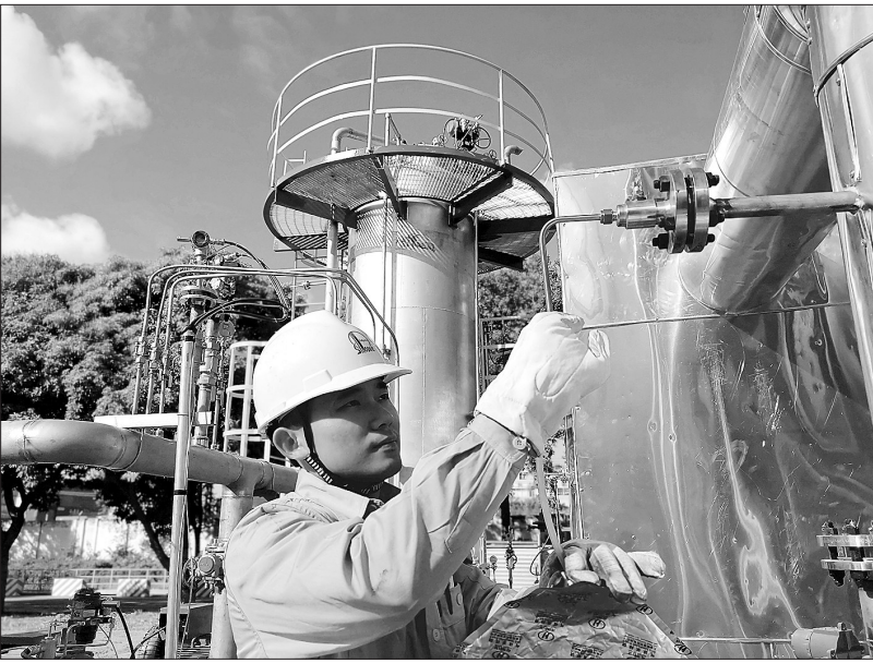
日前,广州石化12号罐区废气提标及重催污水池废气治理项目投用。该项目采用大连(抚顺)石油化工研究院开发的“脱硫及总烃浓度均化-催化氧化”处理技术,可深度净化罐区及重催装置污水池废气,进一步提升罐区VOCs(挥发性和有机物)治理水平。图为1月19日,操作人员来样分析处理后的净化气。 李广群 摄 黄敏清 文
