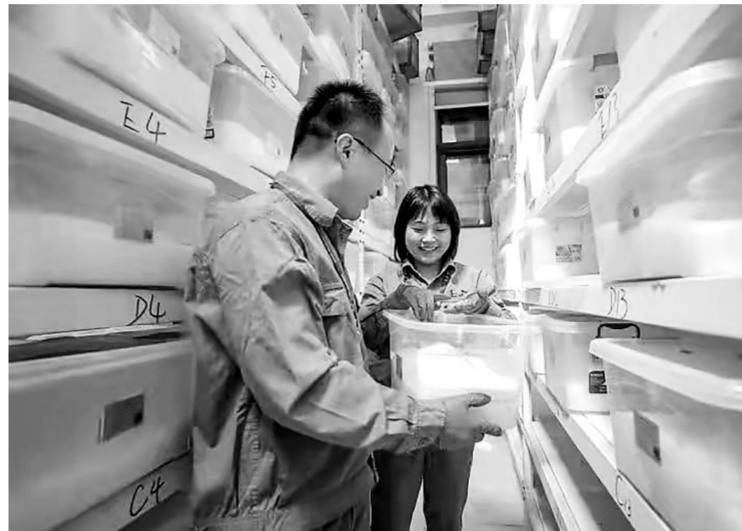
图为树脂技术中心员工对当天产出的高熔指透明聚丙烯专用料GA450进行留样编号存储，保证产品质量可追溯。付松摄
