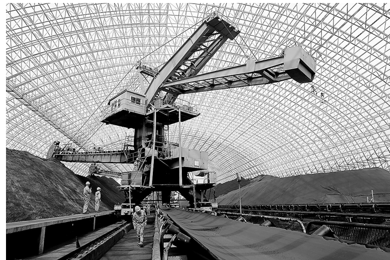
图为热电厂员工在现代化封闭式煤场中对锅炉进行上煤操作。
