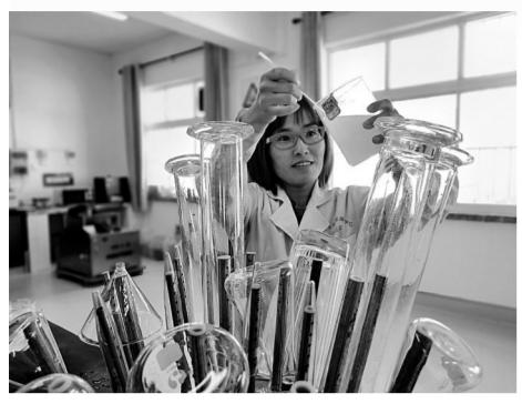
由中原石油工程井下特种作业公司研发的CMHPC酸性压裂液体系,首次在中原油田濮7-140井试验应用,一次压裂成功,压裂后试验井日产液5.5立方米、日产油4立方米,已稳产1个月。图为11月9日,技术人员在观察压裂液交联变化情况。
