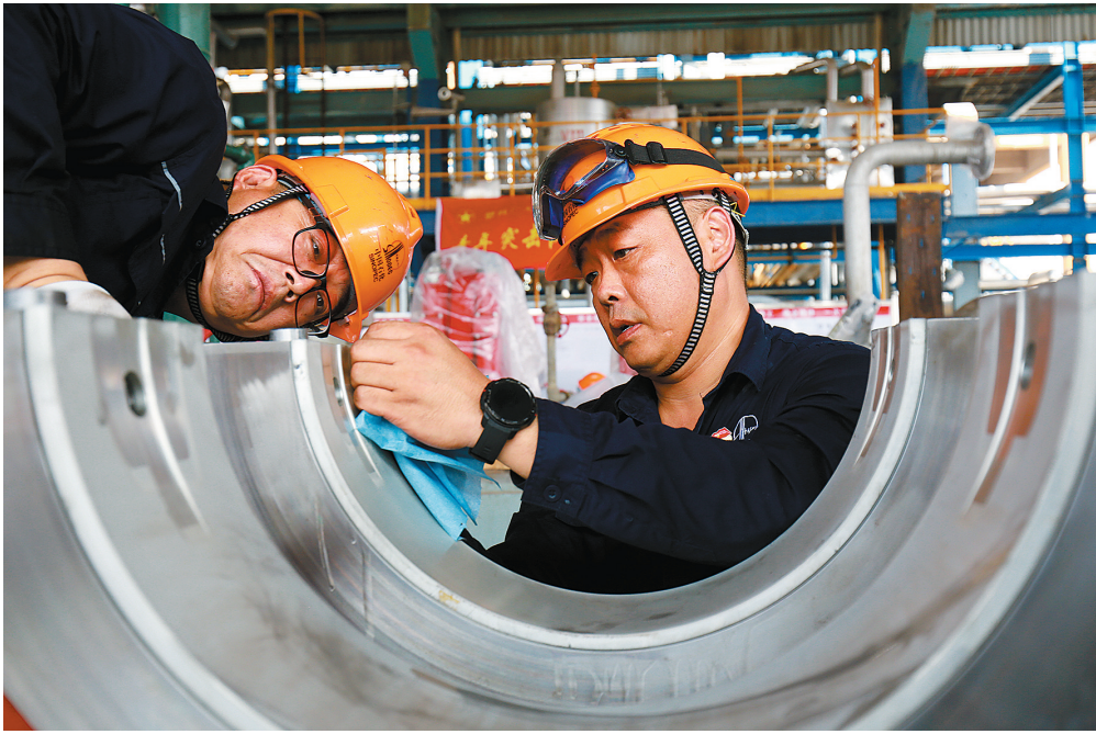
8月6日,在高压压缩机自主维修现场,运维中心技术人员仔细确认装配质量。
