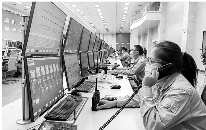
图为聚丙烯运行部主操在联合中控室监控新产品生产参数。侯凤 摄
