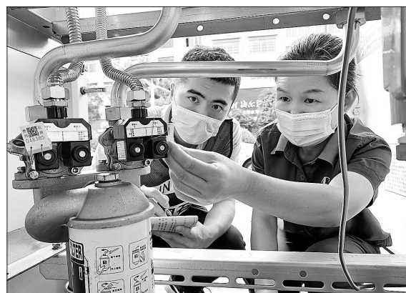
贵州黔东南天柱石油组织县區管區及站長帶頭對加油機主板、計量器、編碼器等重點部位的鉛封進行核對,確保收油期間加油站正常安全運營。圖為加油站員工在檢查設備。 陳浪攝 楊洪振文
