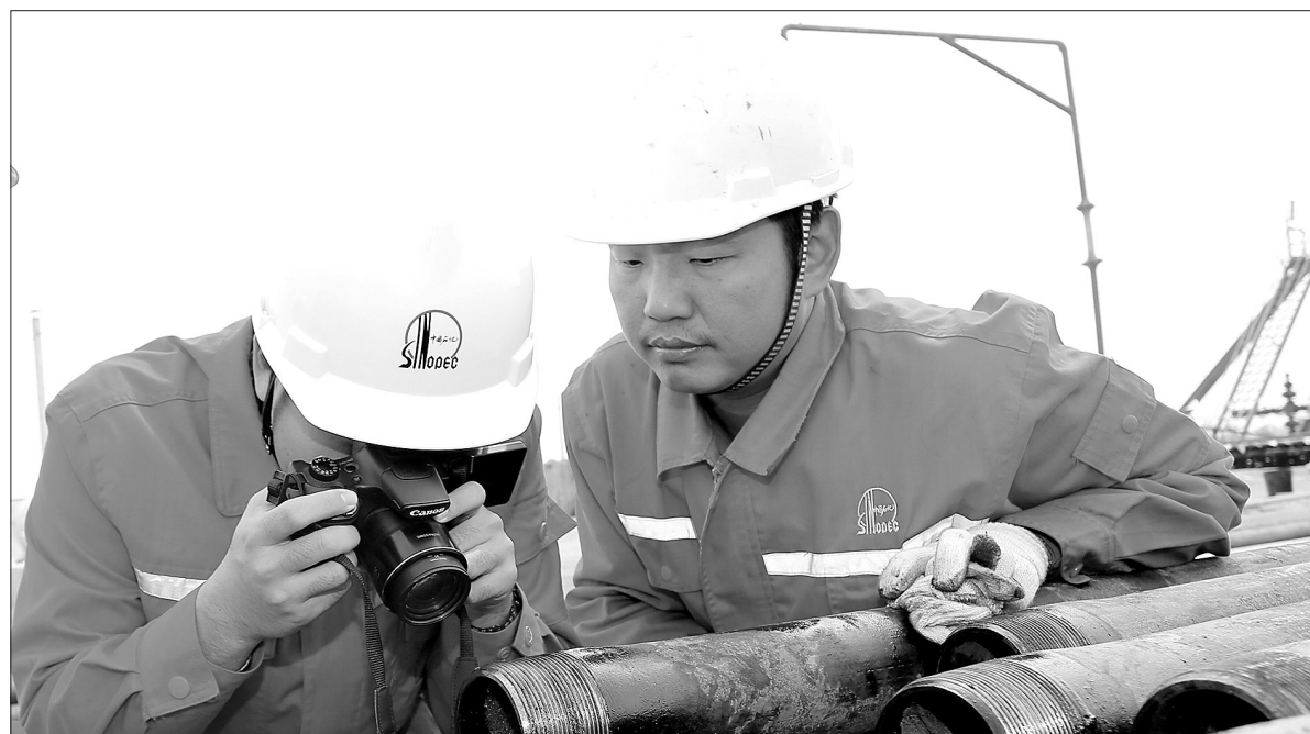
西北油田采油二厂严把作业井施工工艺设计关、开工验收关、现场安全关、作业时效关、入井工具关,加大对作业井质量的检查力度,实施全过程质量风险管控,确保作业提质增效。图为技术人员为油管丝扣拍照,建立健康周期档案。 胡强摄 丁玉萍文
