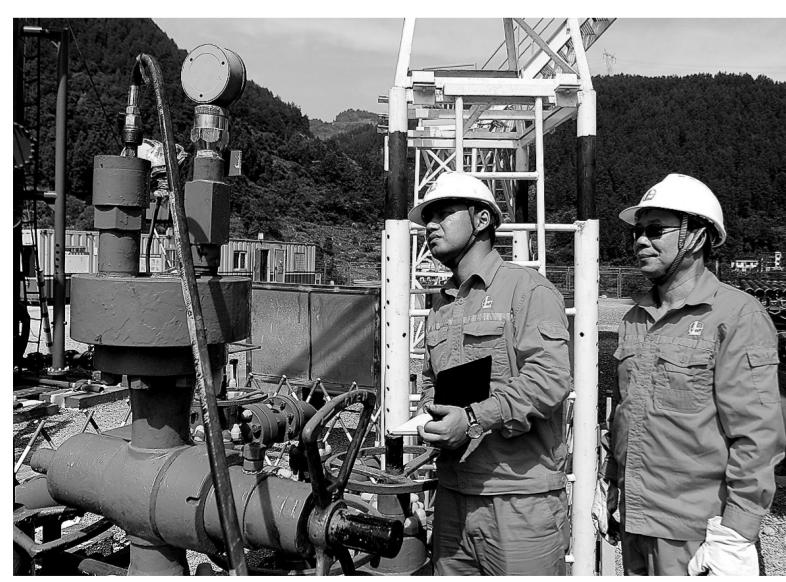
9月2日,江汉油田涪陵页岩气公司开展钻井工程井控交叉检查,共查出问题17个,消除了井控安全隐患。随着气田开发的深入,气田边缘井越来越多,井下条件未知、井控风险增大。涪陵页岩气公司把井控安全摆在首位,提升井控制度的执行力,增强施工单位的应急处置能力,确保钻井井控安全;组织江汉石油工程公司、中原石油工程公司参加井控交叉检查,共同提高井控管理水平。图为管理人员在钻井现场检查节流管汇。 李东勇 戴莹 摄影报道
