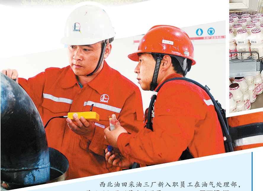
西北油田采油三厂新入职员工在油气处理部,学习用仪器测管线的壁厚。 罗丽娟 摄
