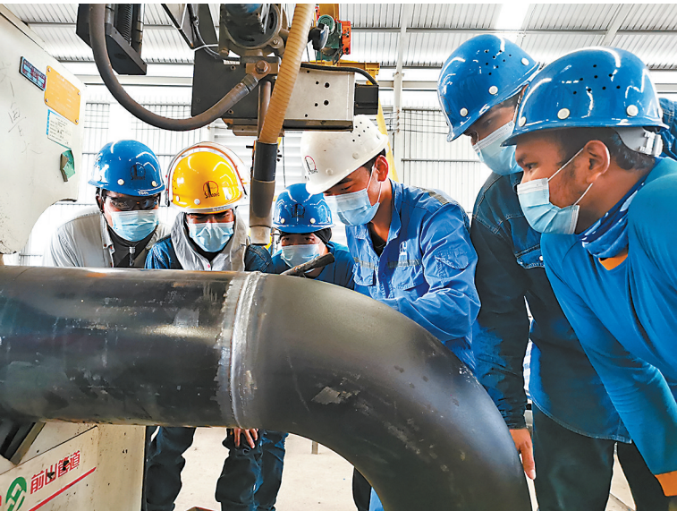
左图:自动焊班长指导泰籍员工学习自动焊接技术。右图:模块化安装理念让钢结构安装“进度条”快速拉进。
