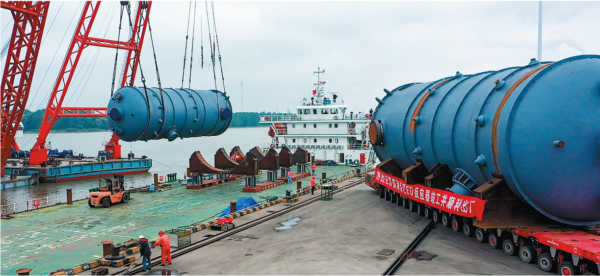
图为南化机制造的镇海基地一期项目两台千吨级EO反应器正在装船发运。
