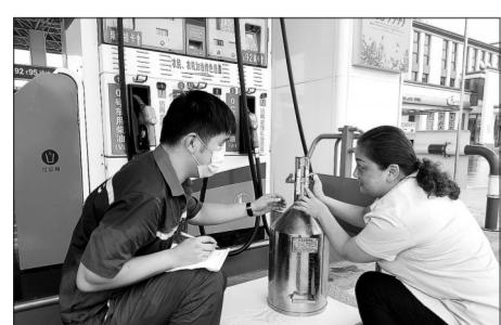
近期，安徽淮南石油大力开展“五查五严”保安全行动，排查风险隐患，强化油品全流程监管。淮南石油加强加油机自校，并按照“国际+内控”双检验要求，申请加油机强检；突击抽查损耗异常的加油站，对卸油操作流程、铅封完好率等进行排查，确保加油站运营安全。图为管理人员在检查洞山中路站加油机自校情况。
