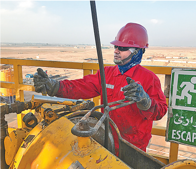
阿西克在钻台操作气动绞车。
