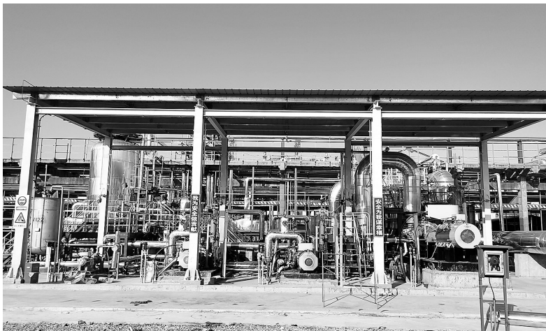
镇海炼化20万吨/年催化油浆无机膜净化装置。
