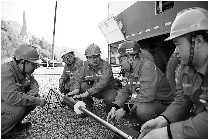
留用博士后徐菲(左三)开展静态磁聚焦阵列套变监测仪的现场试验。于建设 摄
