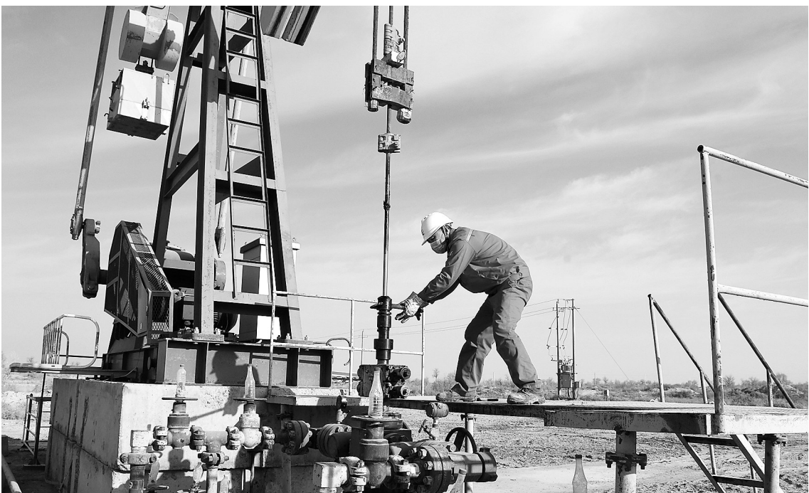
春节期间,西北油田采油一厂加大生产现场巡检力度,采取远程监控、加密巡检次数和优化工艺等多种举措,加强对低产低效井、异常井的管理,解决各类生产异常40余井次,减少产量损失300余吨。图为巡线工人在TK7206井紧固井口盘根盒。
